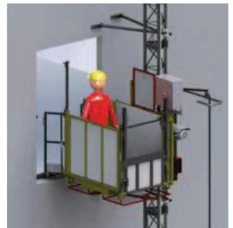
Esempio di installazione con fissaggio a parete e sbarco su finestra.
